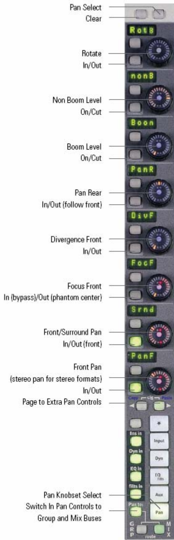
Panneau de contrôle des panoramiques de l'Euphonix S5
