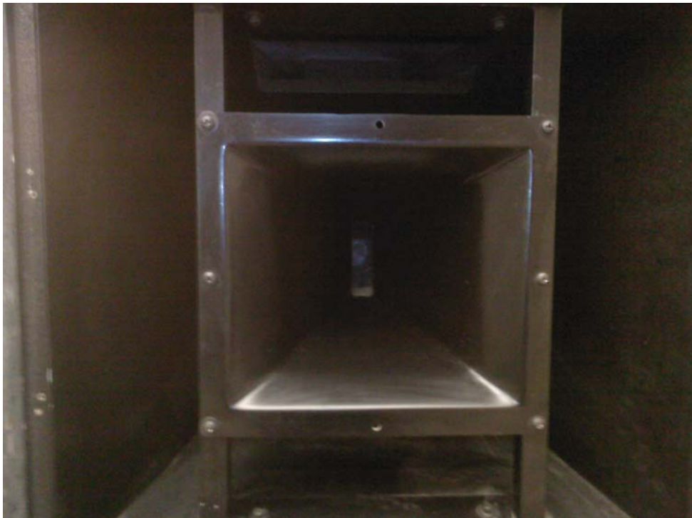
Pavillon conique pour les aigues devant un pavillon exponentiel pour les médiums des KF 850
